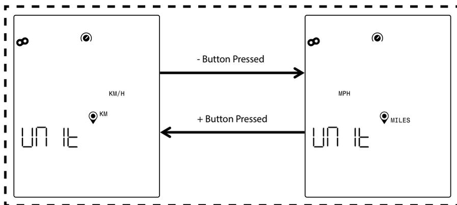
Ils permettent de commuter entre système Métrique et système Impérial. Utilisez les boutons PLUS ou MOINS pour sélectionner l'option voulue. Pour sauvegarder votre choix d'unités, appuyez sur le bouton START/VALIDATION. En appuyant sur ce bouton, le système revient aux écrans de PARAMÉTRAGE. Le réglage des unités par défaut est le système Métrique.
