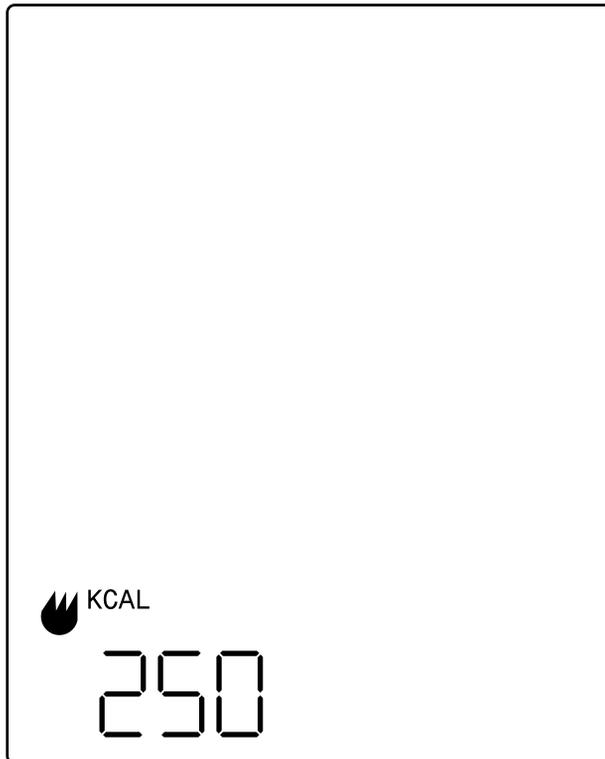
**HINWEIS:** Der obige Bildschirm setzt voraus, dass im Einstellungsmodus die Energie-Auswahl auf KCAL eingestellt ist und das Energieziel daher auf Kilokalorien basiert. Wäre als Einheit KJ eingestellt, würden KJ angezeigt werden, und das Energieziel würde auf Kilojoule basieren.
